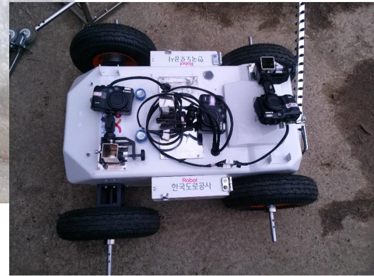
영상 측정을 위한 미니 장비 개발. 모터 제어 측정 차량 개발 (카메라/조명/배터리등)
