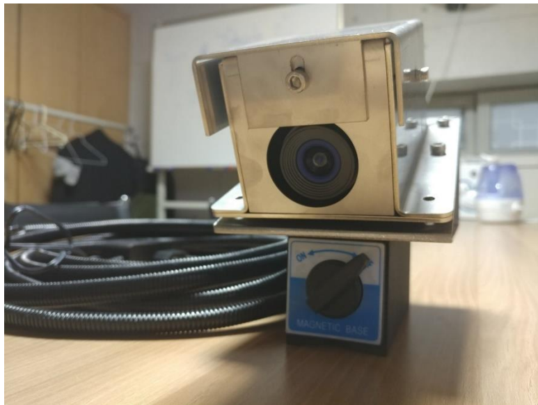
사용된 카메라 (볼트 체결과 자석을 사용한 두가지 모드)
