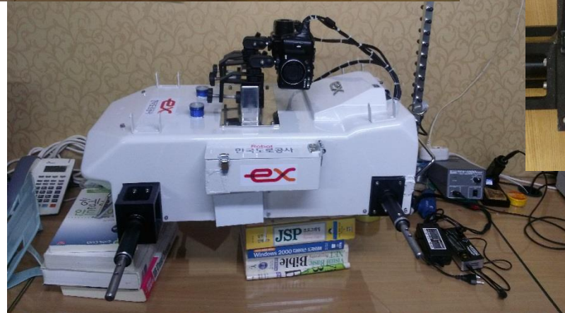
영상 측정을 위한 미니 장비 개발. 모터 제어 측정 차량 개발 (카메라/조명/배터리등)
